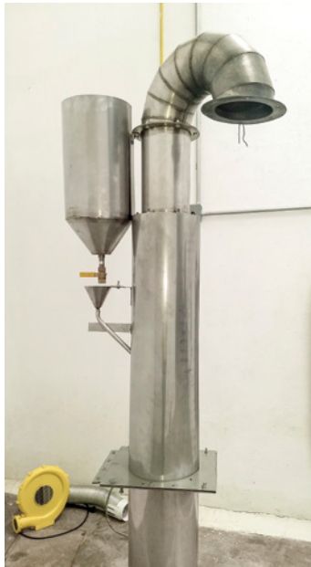
Figura 3. Máquina de uso portátil para expansión o reventado de semillas de amaranto, diseñada en el Colegio de Postgraduados Campus Puebla, Puebla.
